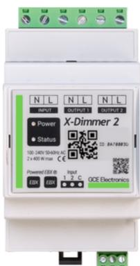
Permet le pilotage de 2 canaux dimmables (400W max/canal)
