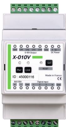
Permet de générer une tension variable entre 0V et 10V sur 4 canaux
